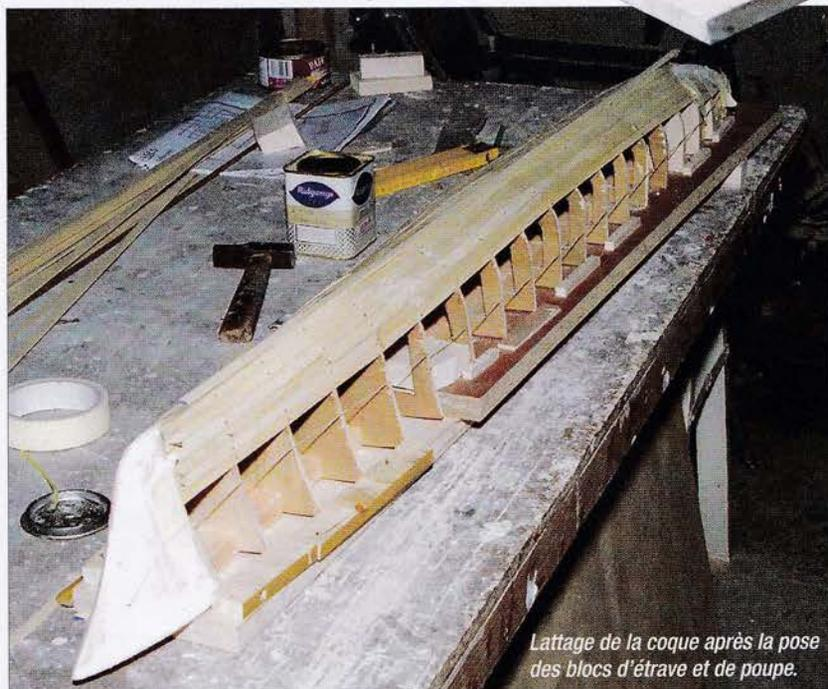
Lattage de la coque après la pose des blocs d'étrave et de poupe.
